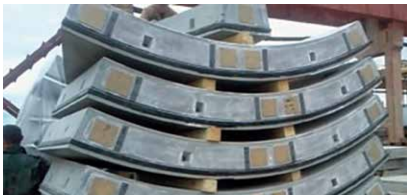
Рисунок 4.7. Высокоточные железобетонные блоки с резиновым контуром, предназначенным для уплотнения стыков изделий при возведении сборных водонепроницаемых обделок
